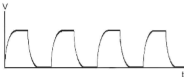
Gambar 4. Bentuk sinyal tegangan dari rangkaian RC
